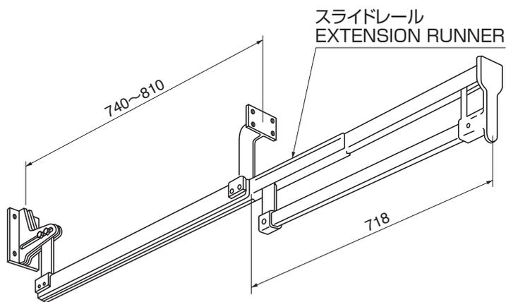
吊下荷重：定格荷重 41kg
